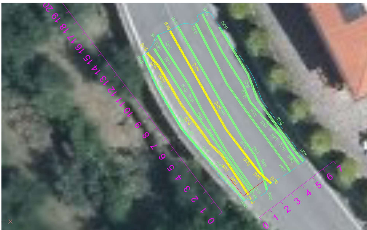
Figura 2 Georadar e Radiodetector, zona di intervento C
