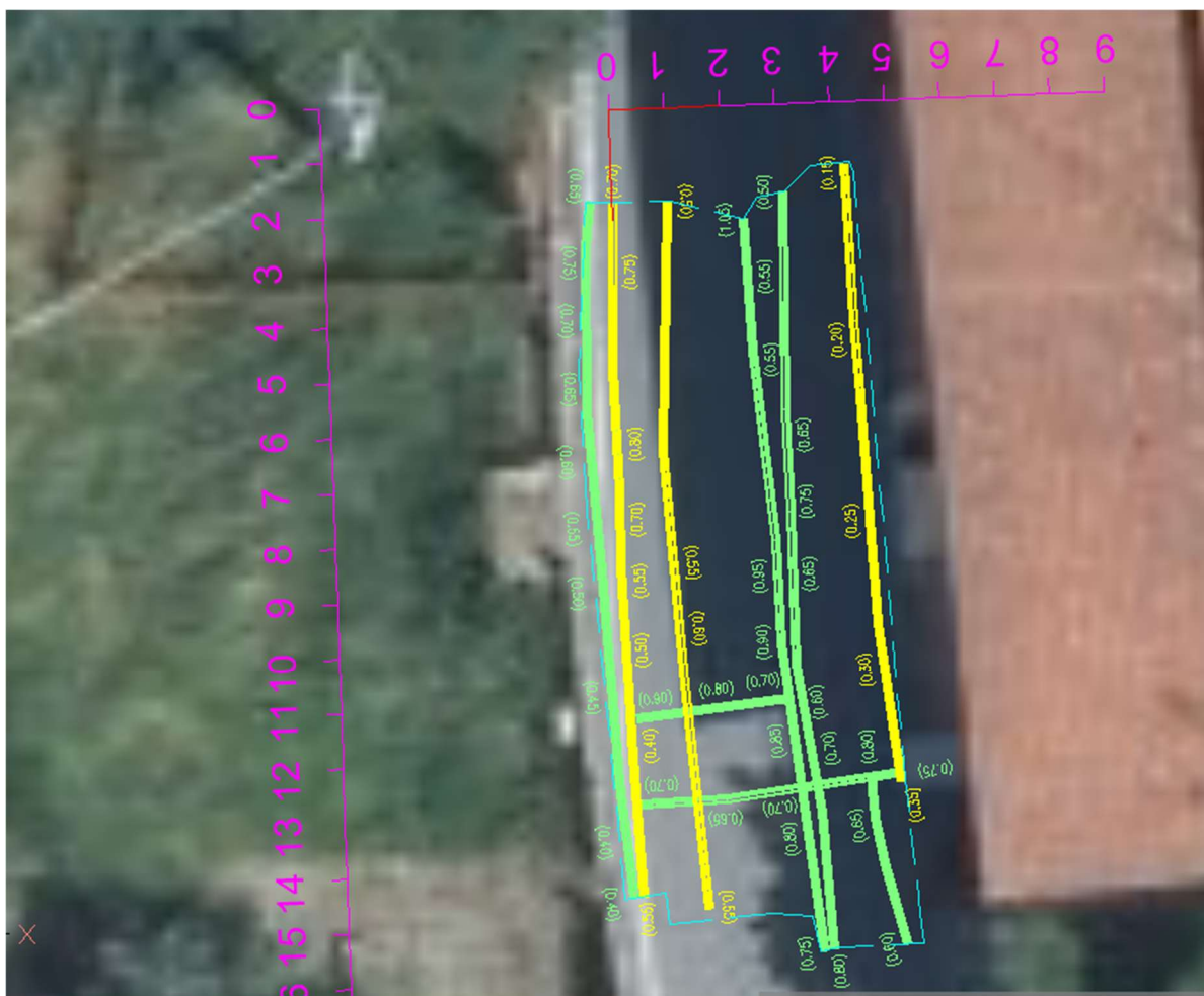
Figura 1 Georadar e Radiodetector, tratto davanti ex caserma dei carabinieri)
