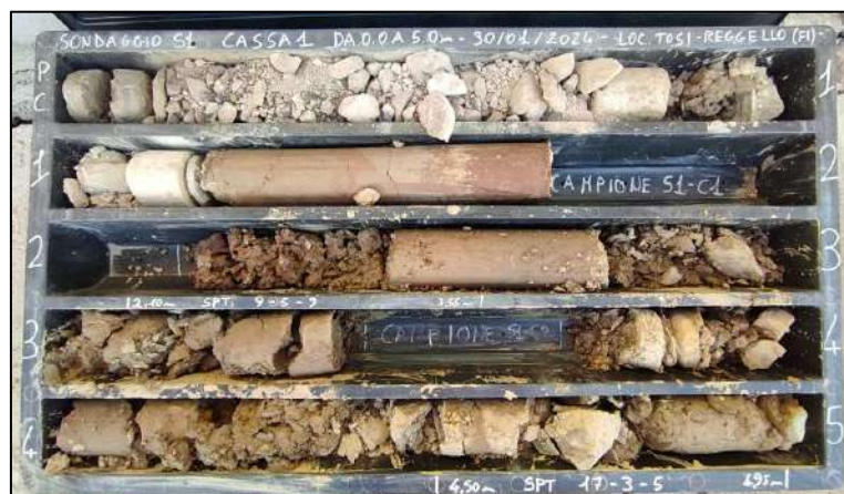
Figura 2: Sondaggio S1-IN - Casseta n.1 da 0.00 a 5.00 metri
