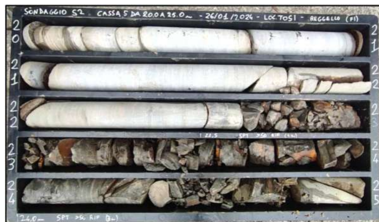
Figura 15: Sondaggio S2-DH - Cassetta n.5 da 20.0 a 25.0 metri
