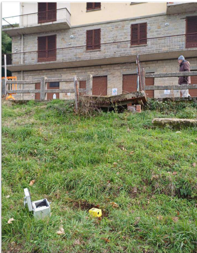
FIGURA 2 – STRUMENTAZIONE UTILIZZATA E POSIZIONAMENTO PROVA HVSR 01
