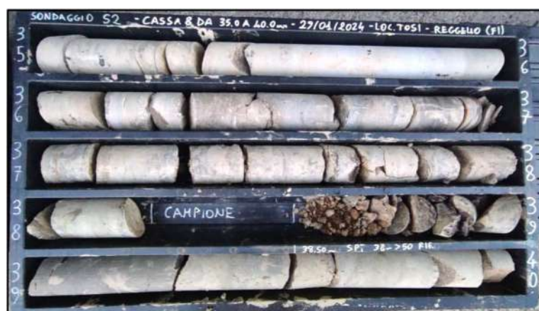
Figura 18: Sondaggio S2-DH - Cassetta n.8 da 35.0 a 40.0 metri
