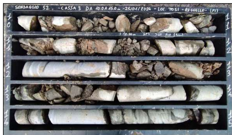
Figura 13: Sondaggio S2-DH - Cassetta n.3 da 10.0 a 15.0 metri
