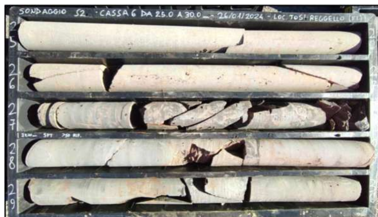
Figura 16: Sondaggio S2-DH - Cassetta n.6 da 25.0 a 30.0 metri
