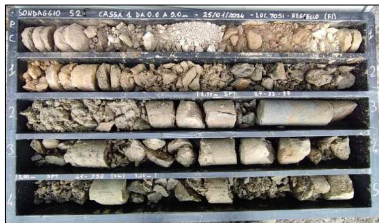
Figura 11: Sondaggio S2-DH - Cassetta n.1 da 0.00 a 5.00 metri
