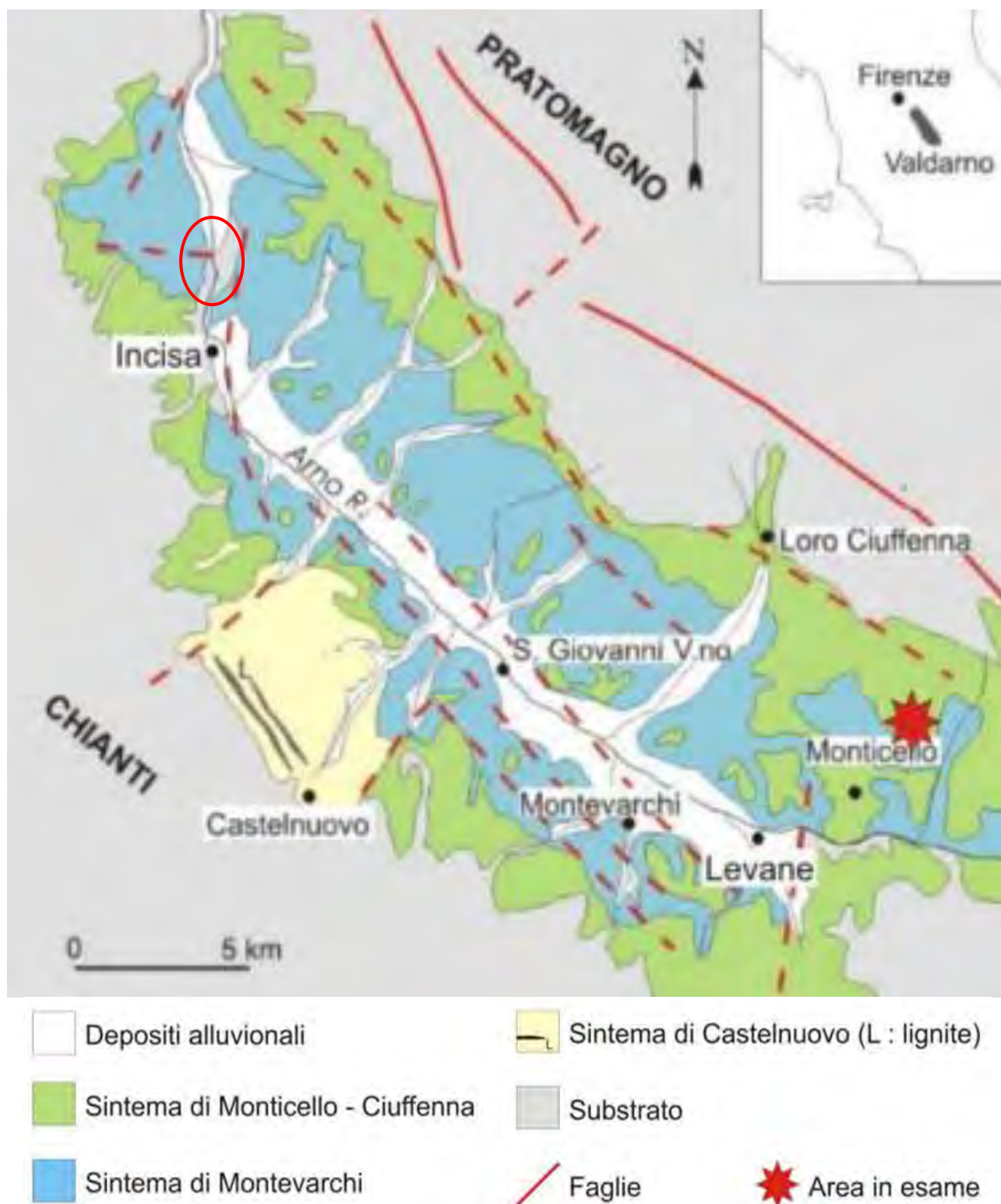
Figura 3 - inquadramento geografico e carta geologica schematica del Bacino del Valdarno Superiore (Fonte: TESI DI LAUREA MAGISTRALE IN GEOLOGIA E GEOLOGIA TECNICA - I DEPOSITI GHIAIOSI PLEISTOCENICI DEL PALEO-ARNO (TOSCANA CENTRALE, ITALIA): FACIES SEDIMENTARIE ED ARCHITETTURE DEPOSIZIONALI – Marcella Roner).
