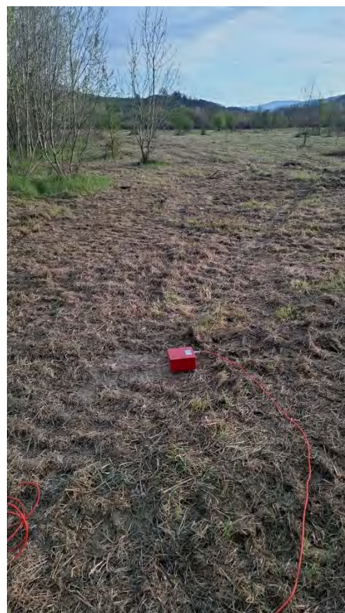
Indagine sismica passiva a stazione singola HVSr
