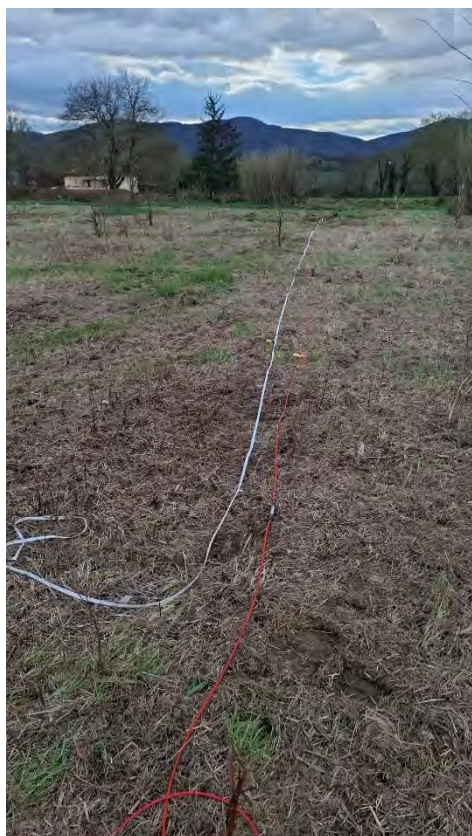
Stesa sismica antenna ESAC (lato corto)
