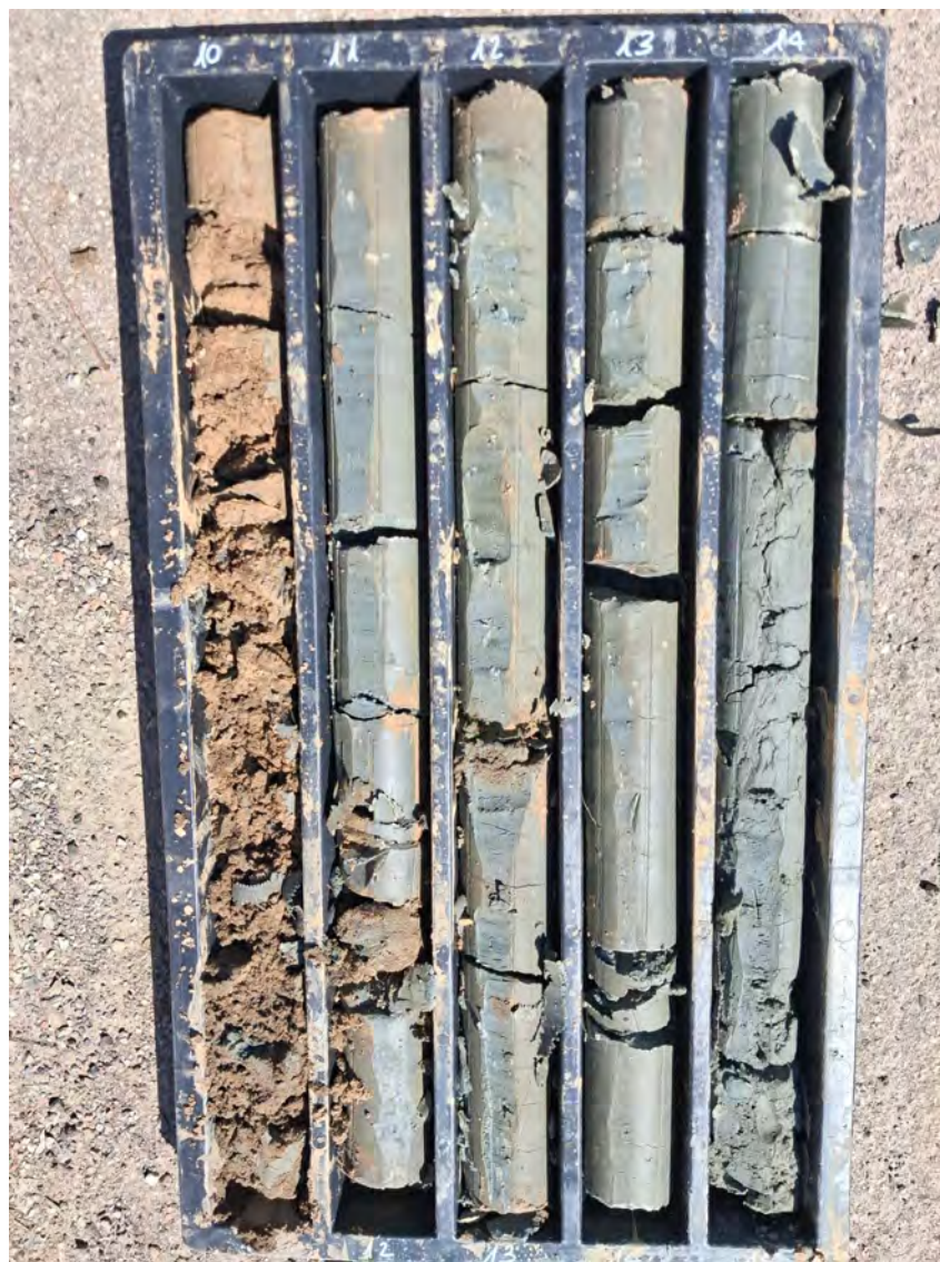
Sondaggio S1 - da 10.00 m. a 15.00 m.
