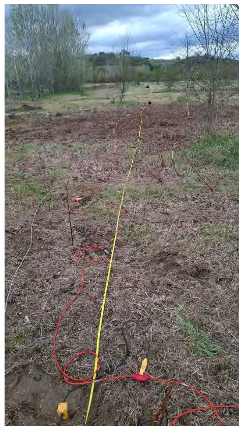
Stesa sismica MASW+ESAC (lato lungo)
