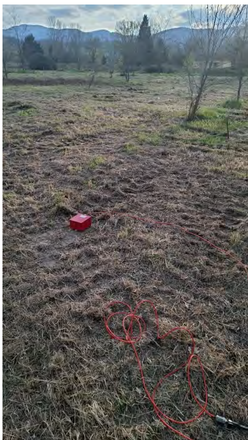
Indagine sismica passiva a stazione singola HVSr
