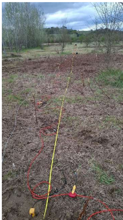
Stesa sismica MASW+ESAC (lato lungo)
