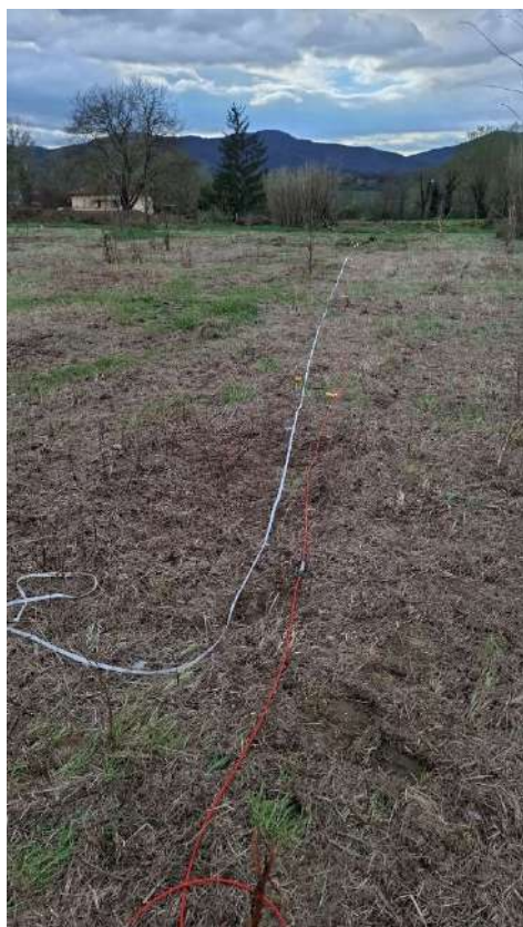
Stesa sismica antenna ESAC (lato corto)
