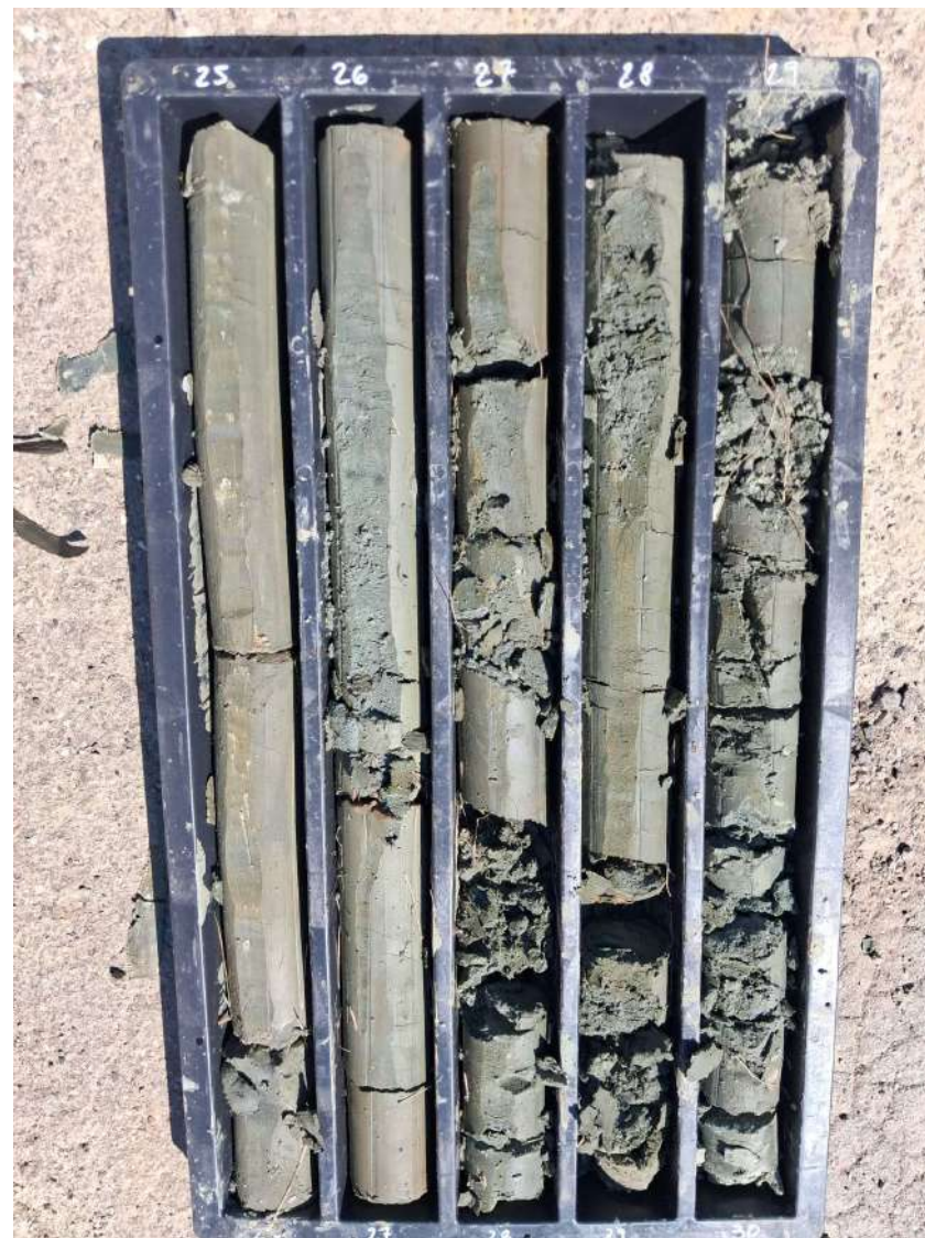
Sondaggio S1 - da 25.00 m. a 30.00 m.
