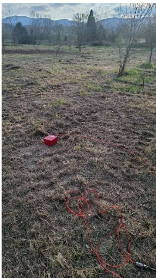
Indagine sismica passiva a stazione singola HVSr
