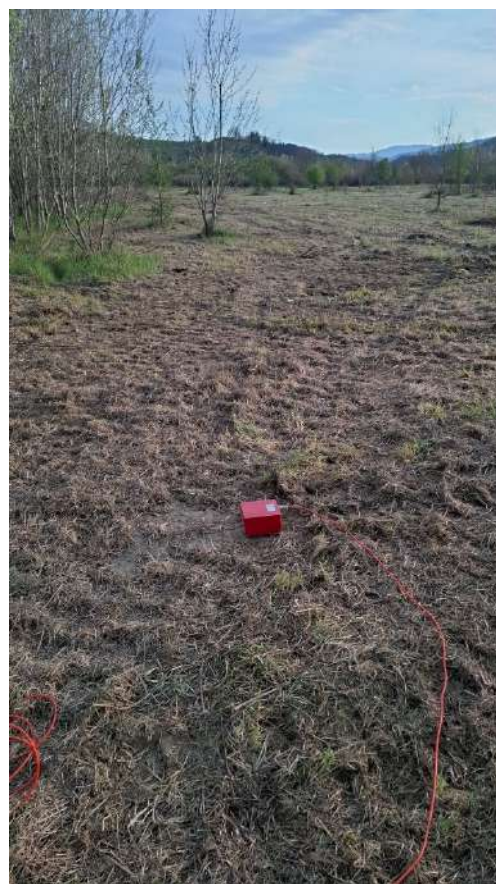
Indagine sismica passiva a stazione singola HVSr
