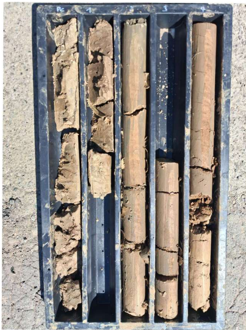
Sondaggio S1 - da P.C. a 5.00 m.
